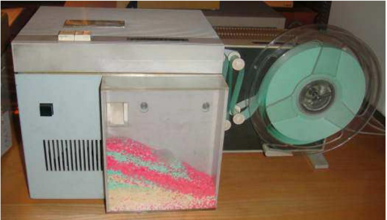
Abb. 1 Lochbandstanzer robotron 1215-1001 mit Abspulgerät 1227-2001
