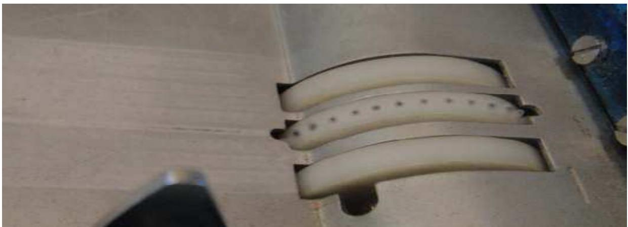
Abb. 4 Stachelrad am Stanzer
