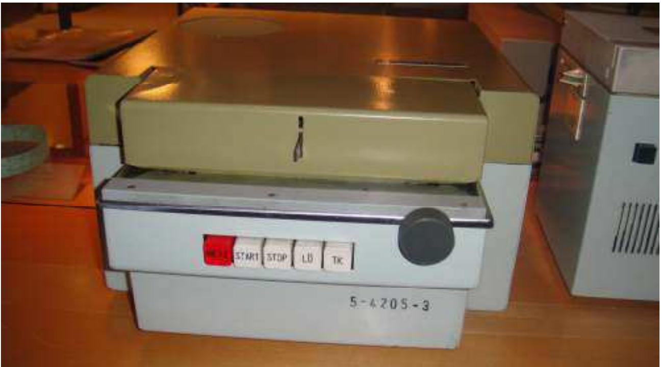
Abb. 2 Lochbandleser robotron 1210-0333
